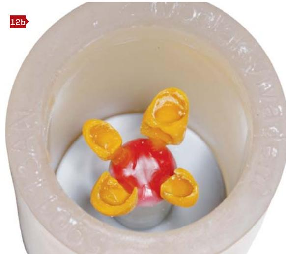
Figuras 12 - Padrões montados em base formadora de cadinho [A] e anel de fundição [B].
